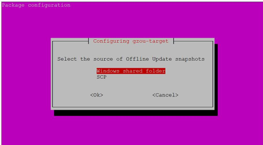
Автономный экземпляр GravityZone - настройка режима передачи файлов обновлений
