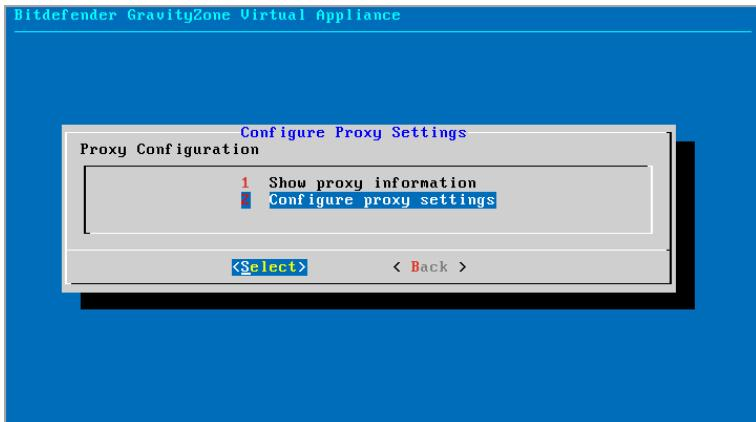
Интерфейс консоли устройства: настройка параметров прокси-сервера
